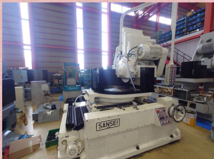
横軸ロータリー研削盤 三正 GK-8 チャック径800φ ストローク:上下555 左右550 管理番号:P008403 置場:東日本マシンプラザ
