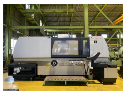
平面研削盤 岡本工作 PSG-84CA 2012年製 チャックサイズ'800×400 管理番号:H018198 置場:マシンブラザ本庄
