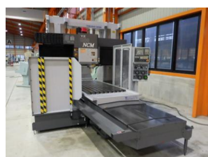
門型NCフライス 山崎技研 YZ-1121 2015年製 BT50 テーブルサイズ2000×920 管理番号:H018205 置場:マシンプラザ本庄
