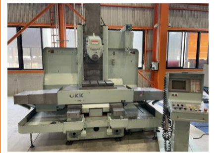
NC横フライス OKK MHA-460 1998年製 MELDAS500 NT50 管理番号:H017719 置場:マシンプラザ本庄
