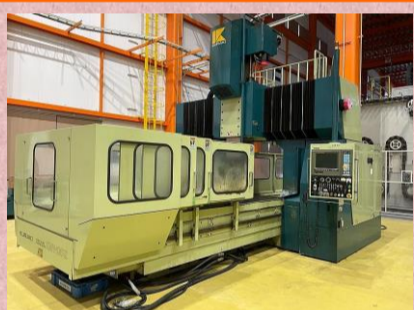
門型マシニングセンター 倉敷機械 KMV-130Z 1994年製 FANUC-15M BT50 ATC90本 管理番号:H018018 置場:マシンプラザ本庄
