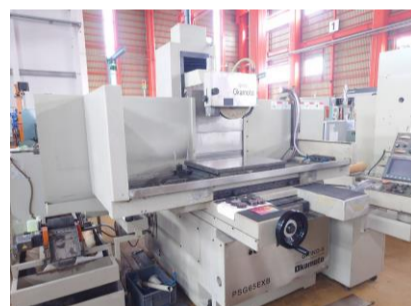
NC平面研削盤 岡本工作 PSG-65EXB 2005年製 チャックサイズ'600×500 管理番号:P008163 置場:東日本マシンブラザ
