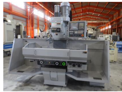
NC立フライス 山崎技研 YZ-350NCR 2019年製 FANUC32i-B BT50 管理番号:H018468 置場:マシンプラザ本庄
