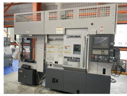
複合NC旋盤 オークマ LB2000EX 2011年製 OSP-P200LA 6吋3爪チャック 管理番号:H017646 置場:マシンプラザ本庄
