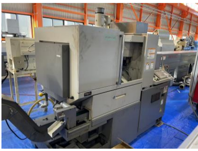
NC自動盤 シチズン A20VIPL 2006年製 FANUC ローターガイトブッシュ 管理番号:H018392 置場:マシンプラザ本庄
