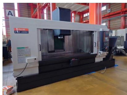
立型マシニングセンター ヤマザキマザック VTC-200C 2006年製 MAZATROL 640M BT40 ATC24 管理番号:P008644 置場:東日本マシンブラザ
