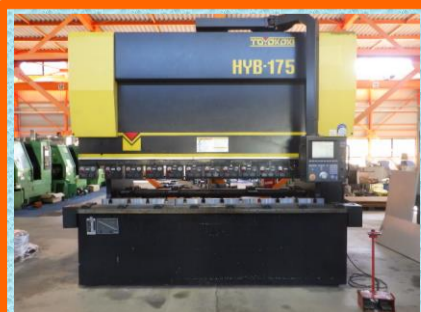
NCベンダー 東洋工機 HYB-17530 2004年製 175t テーブル長さ3000 ストローク長さ2000 管理番号:H016940 置場:マシンプラザ本庄
