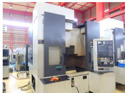
立型マシニングセンター 森精機 NV4000 2004年製 MSX-501(FANUC) BT40 管理番号:P008637 置場:東日本マシンブラザ
