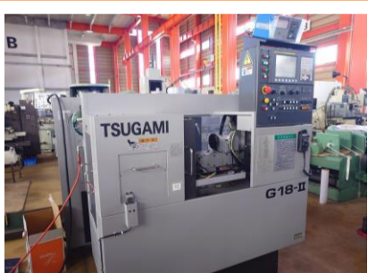
NC円筒研削盤 ツガミ G18-II AB 2012年製 FANUC0i-TD テーブル上の振り180 管理番号:P008545 置場:東日本マシンプラザ
