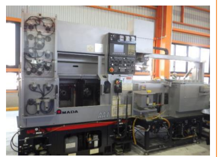
複合NC旋盤 アマダ AA-1 2012年製 FANUC31i-A 平行2スピンドル 管理番号:H017865 置場:マシンプラザ本庄
