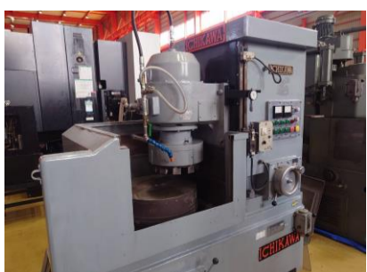
ロータリー研削盤 市川 ICB-603 1989年製
