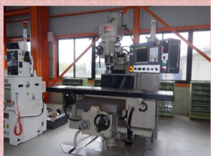
NC立フライス 遠州 SEV-B 1998年製 FANUCOi-Mate MD NT40 管理番号:H017660 置場:マシンプラザ本庄
