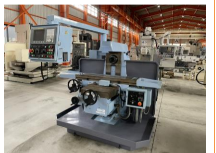
NC横フライス 岩下 NH2 2008年製 FANUC 0i-MC NT50 管理番号:H018007 置場:マシンプラザ本庄
