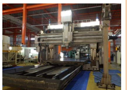
五面加工機 オークマ MCR-BII 35×50 2004年製 OSP-E100M BBT50 管理番号:H015701 置場:マシンプラザ本庄
