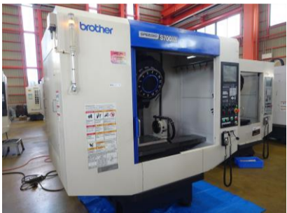
タッピングセンター ブラザー S700X1 2015年製 CNC-C00 BT30 ATC14本 管理番号:P008613 置場:東日本マシンプラザ
