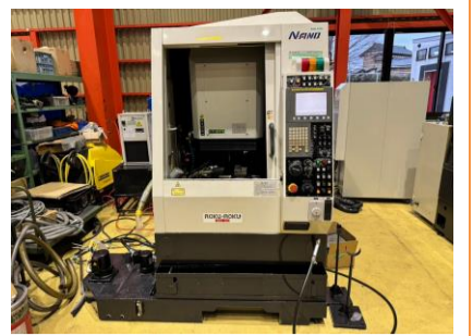
立型マシニングセンター 碌々産業 NANO-21 2006年製 FANUC-31i-A5 HSK-E25 管理番号:P008457 置場:東日本マシンプラザ
