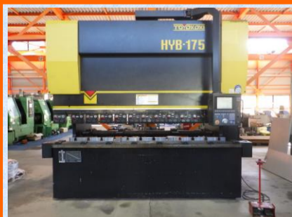
NCパンダー 東洋工機 HYB-17530 2004年製 175t テーブル長さ3000 ストローク長さ2000 管理番号:H016940 置場:マシンプラザ本庄
