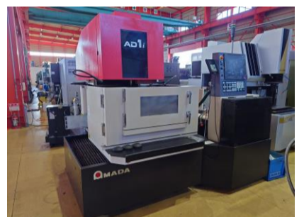
NCワイヤーカット アマダ AD1 2017年製 FANUC-31i-WB ワイヤー径0.1-0.3 管理番号:P008235 置場:東日本マシンプラザ
