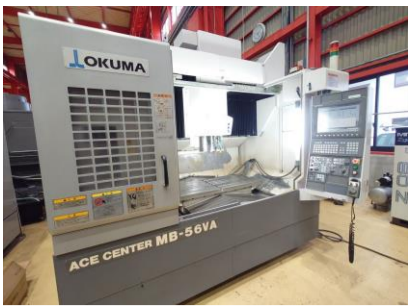
立型マシニングセンター オークマ MB-56VA 2006年製 OSP-P200M BT40 管理番号:P008519 置場:東日本マシンプラザ
