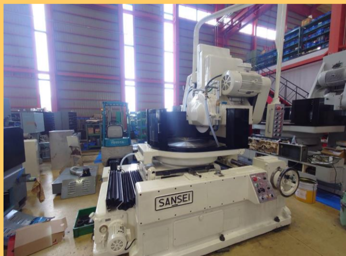
横軸ロータリー研削盤 三正 GK-8 チャック径800φ スローク:上下555 左右550 管理番号:P008403 置場:東日本マシンプラザ
