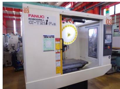
ドリリングセンター ファナック alpha-T21iFLa 2009年製 FANUC31i-A5 BT30 管理番号:P008529 置場:東日本マシンプラザ
