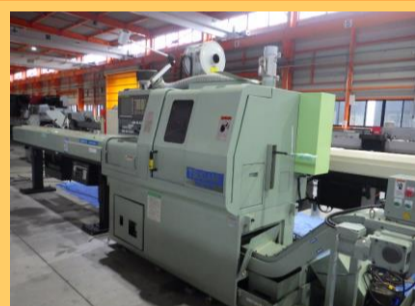
NC自動盤 ツガミ BS18(K)-III 2005年製 FANUC31i-A 外径バイト5本取付可能 管理番号:H016063 置場:マシンプラザ本庄
