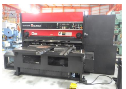
シャーリング アマダ DCT-1213 1993年製 13×1260 電動クランプ 管理番号:H016028 置場:マシンプラザ本庄
