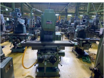
ひざ型フライス 大隈豊和 STM-2V 1989年製 NT50 テーブルサイズ1500×310 管理番号:H017366 置場:マシンプラザ本庄
