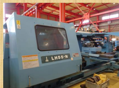
フラット型NC旋盤 オークマ LH55-NB 1996年製 OSP7000L φ750.4爪単動チャック 管理番号:P006389 置場:東日本マシンプラザ
