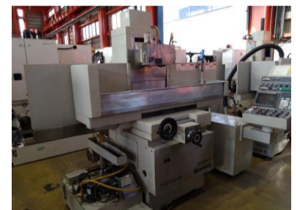
NC平面研削盤 岡本工作 PSG-52EXB 2005年製 チャックサイズ500×200 管理番号:P008041 置場:東日本マシンプラザ
